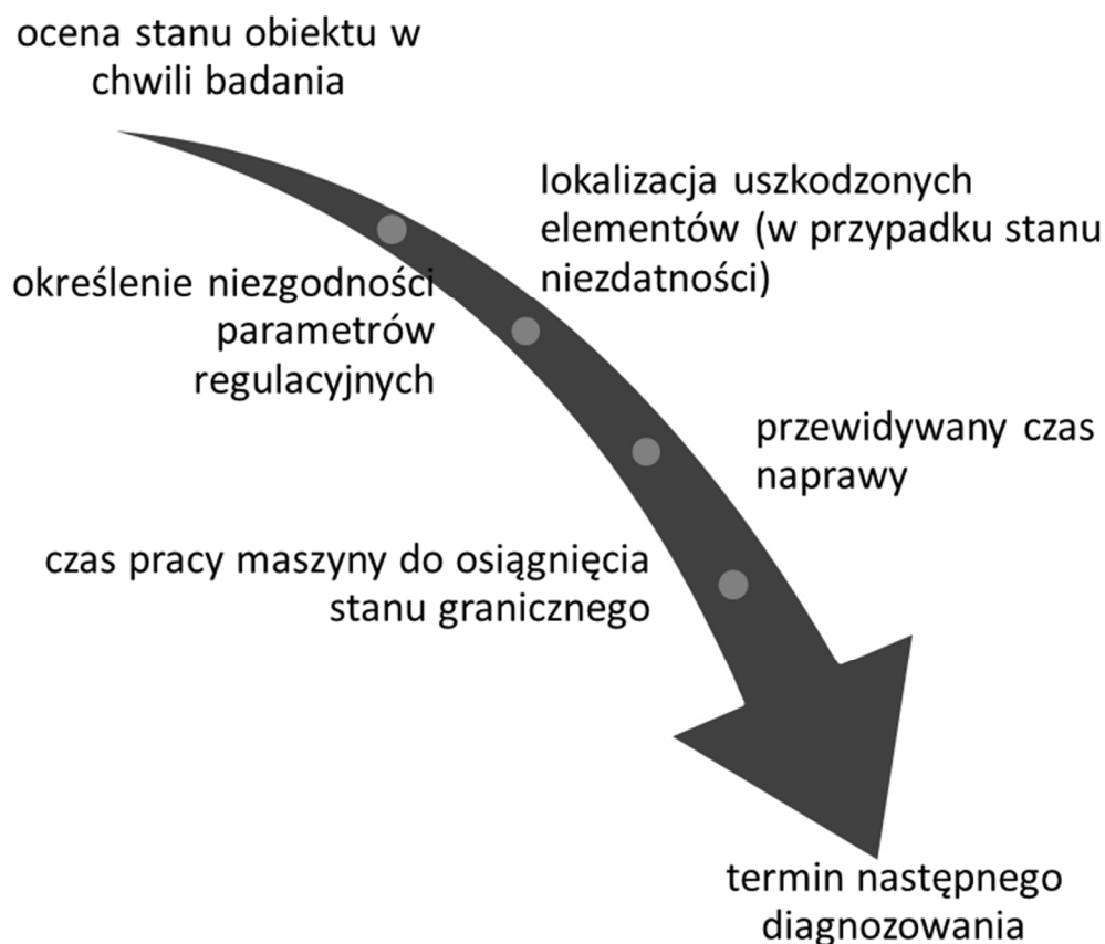
Rys. 1.8 Algorytm postępowania podczas procesu diagnostycznego
