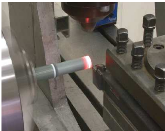
Rys. 3.20. Schemat obróbki hybrydowej
