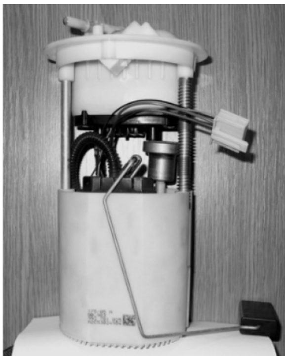
Rys. 14. Zintegrowana pompa paliwa z pływakim ramieniowym wykorzystującym czujnik potencjometryczny do monitorowania stanu paliwa
