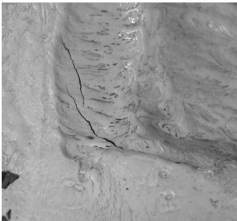
Rys. 9. Badania nieniszczące metodą magnetoproszkową materiałów ferromagnetycznych Źródło: opracowanie własne
