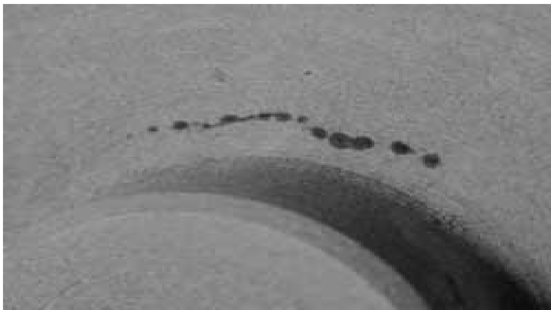
Rys. 10. Badania nieniszczące metodą penetracyjną materiałów stalowych Źródło: opracowanie własne
