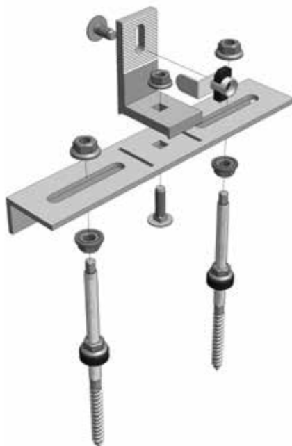
Rys. 17. Śruby dwugwintowe + kołnierz podwójny (np. do montażu na dachach krytych blachą trapezową)
