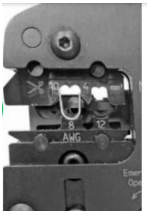
Rys. 28. Prawidłowe umiejscowienie konektora w prawce
