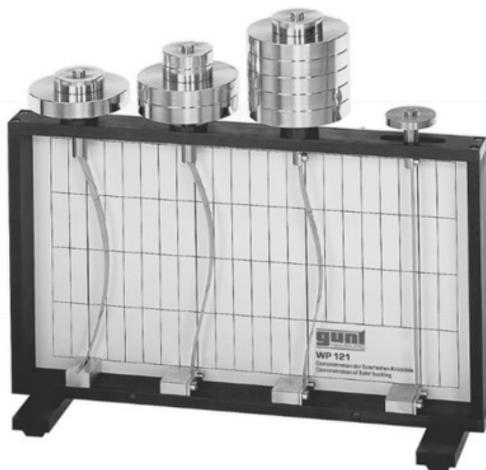
Rys. 29. Demonstracja przypadków wyboczenia Eulera na stanowisku laboratoryjnym Akademii Nauk Stosowanych w Koninie, prod. G.U.N.T. Gerätebau GmbH (od lewej: pręt obustronnie przegubowy; pręt jednostronnie przegubowy i utwierdzony na drugim końcu; pręt obustronnie utwierdzony; pręt utwierdzony na jednym końcu, a drugi koniec jest wolny)
