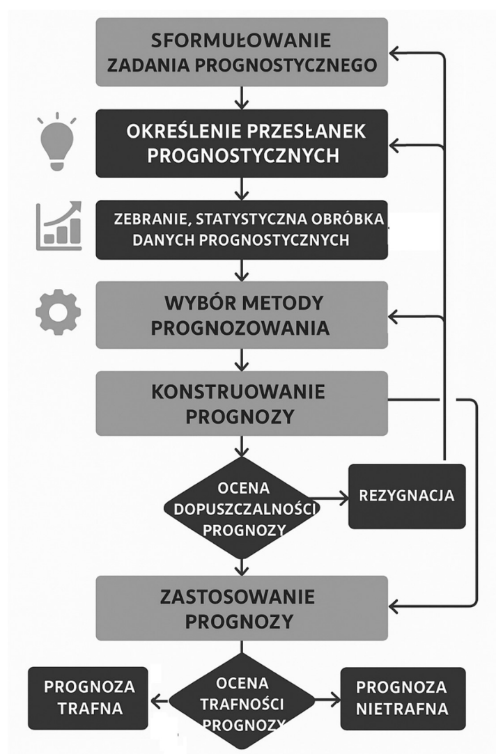
Rys. 7. Schemat procesu prognostycznego
