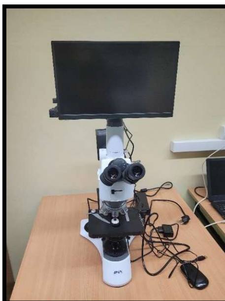
Rys. 4. Mikroskop metalograficzny Delta Optical MET-1000 TRF, Źródło: opracowanie własne, fotografia z kolekcji autorki
